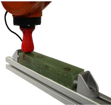
Bild 1: Prüfaufbau an einer dickwandigen (30 mm) GFK-Probe
