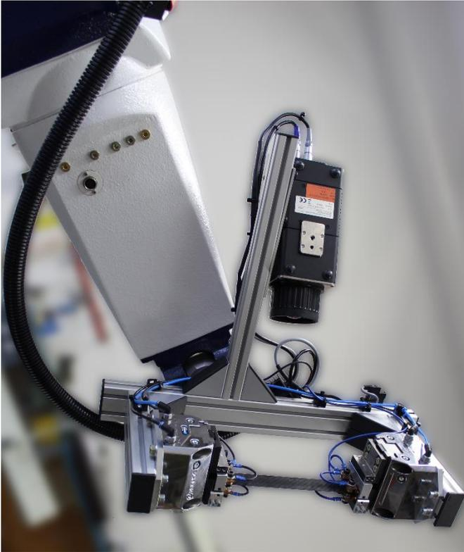
Bild 1: Vollautomatisierte Widerstandserwärmung faserverstärkter thermoplastischer Halbzeuge
