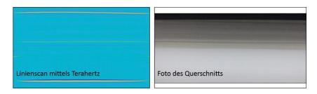
Bild 1: Querschnitt eines Kraftstofftanks, hergestellt im Extrusionsblasverfahren. Die Schichten bestehen aus (von oben nach unten) einer PE Schicht mit Kohlenstoff versetzt, einer PE Schicht mit Kohlenstoffrückständen, einer EVOH Barriereschicht und einer abschließenden PE Schicht.
