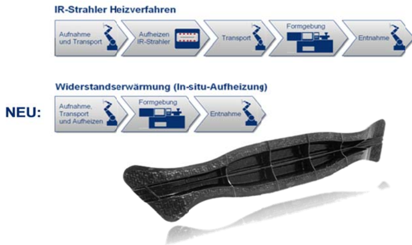
Bild 1: Konventionelle Aufheizverfahren erfordern mehr Schritte als die Widerstandserwärmung faserverstärkter thermoplastischer Halbzeuge
