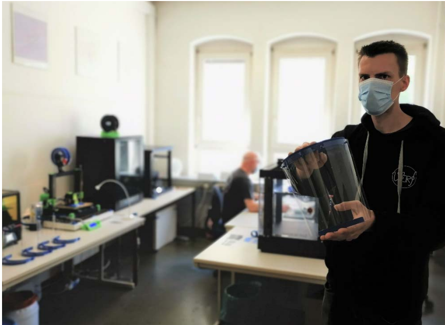
Bild 1: Herstellung der Schutzvisiere aus biobasiertem und biologisch abbaubarem PLA im 3D-Druck-Labor des IKT der Universität Stuttgart
