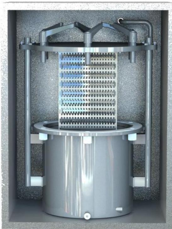
*Bild 1: In Autoklaven wie diesem werden Prüfkörper auf ihre Temperatur- und Medienbeständigkeit in einem Glykol-Wasser-Gemisch bei 135 °C untersucht. Um das Sieden des Wassers während der Versuche zu vermeiden, ist eine Lagerung unter erhöhtem Druck nötig.*
