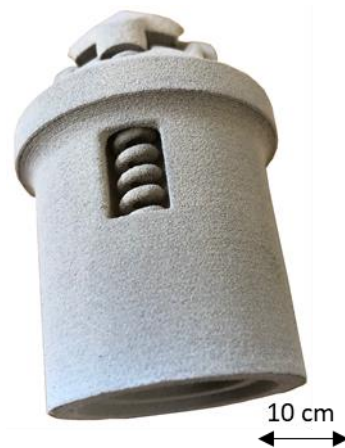
Versuchsbauteil mit innerer Mechanik, gefertigt von Fa. RAUCH mit einem CO 2 -Laser und PPS GF
