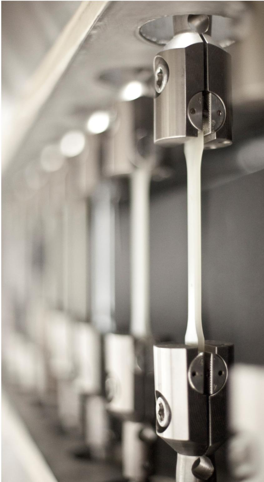
**Abbildung 1: Bis zu 60 Prüfkörper finden in der Zeitstandanlage des IKT Platz – 30 davon auch temperiert bis 220°C (Bild: IKT)**
