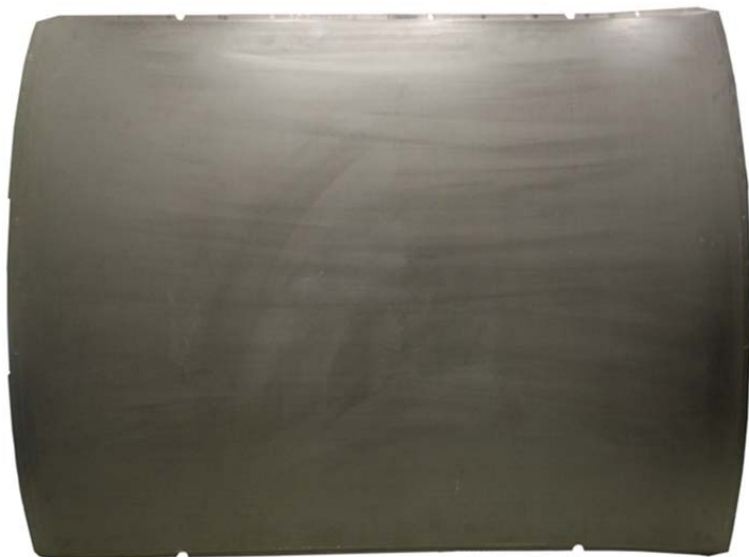
Bild 1 CFK Automobildach nach Hageleinschlag: keine sichtbare Schäden
