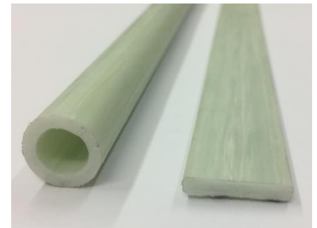
Durch In-Situ Pultrusion hergestellte endlosfaserverstärkte, thermoplastische Profile (IKT)
