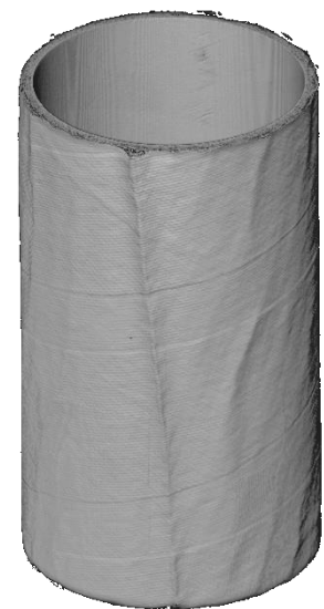
Computertomografischer Scan einer CFK-Welle
