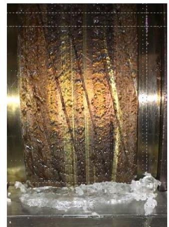
Bild 3: Abtransport von Schmelze
