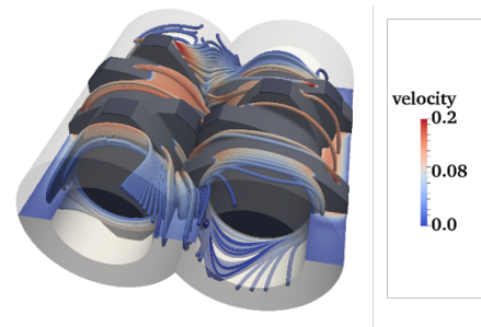
Abbildung 2: Die Geschwindigkeit innerhalb eines DSE als Strömungslinien
