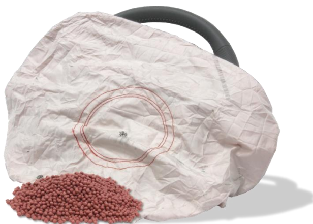
Bild 1: Silikonhaltige Airbagabfälle werden zu einem Rezyklat für technische Anwendungen reaktiv aufbereitet.
