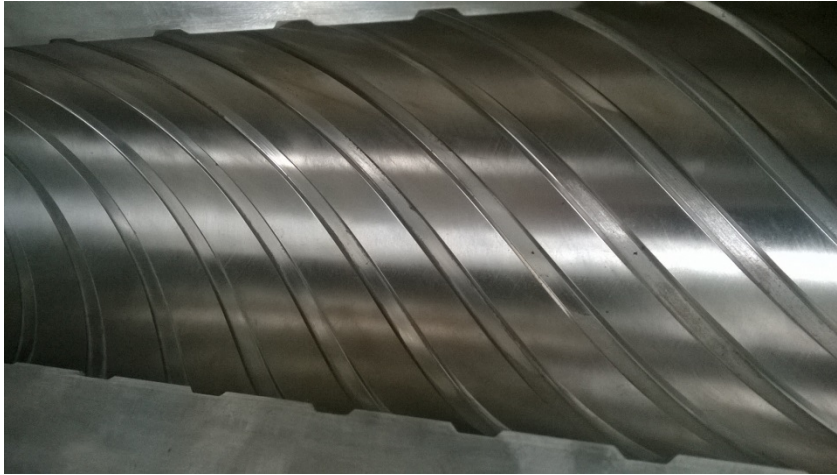
Abbildung 1: Aufgeschnittener Zylinder mit genuteter Plastifizierzone für höchste Energieeffizienz.
