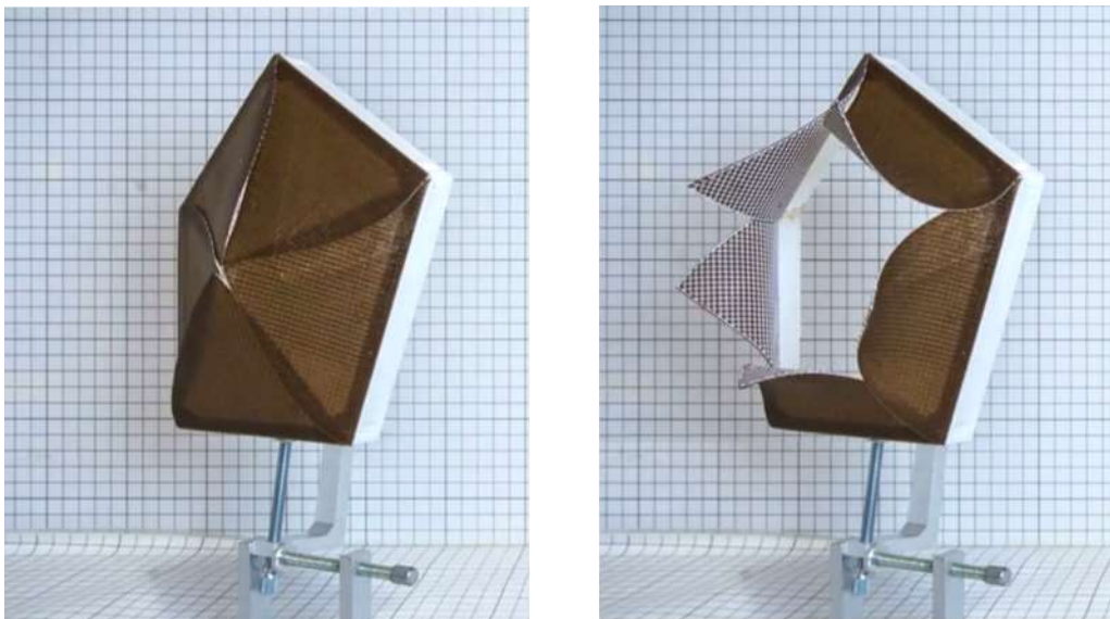
Bild 1: Generativ hergestellter Demonstrator bei 90 % relativer Luftfeuchtigkeit (rLF) (links) und bei 30 % rLF (rechts); bislang jedoch ohne biobasierte Werkstoffe
